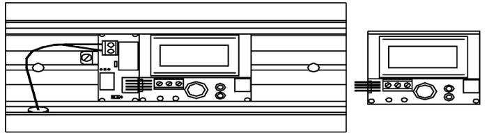
4) Mit zwei Schrauben befestigen. Modul wieder einschieben. Turbinenkabel (3 x 0.5 m<sup>2</sup>) an klemmen.
